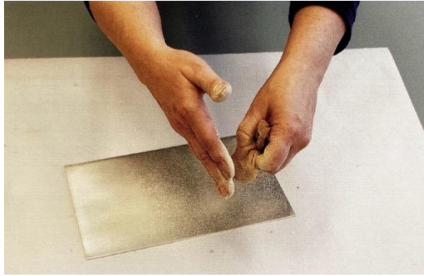
Resim 2.12. Toz Reçinenin Tül Yardımıyla Plaka Üzerine Serpiştirilmesi
