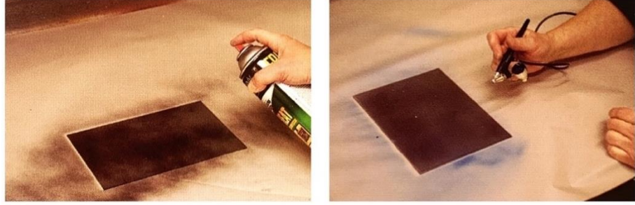
Resim 2.14. Sprey Boya ve Airbrush ile Plaka Üzerine Boya Aktarma İşlemi
