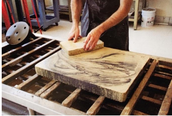
Resim 2.21. Taş Taşa Grenleme Yöntemi
