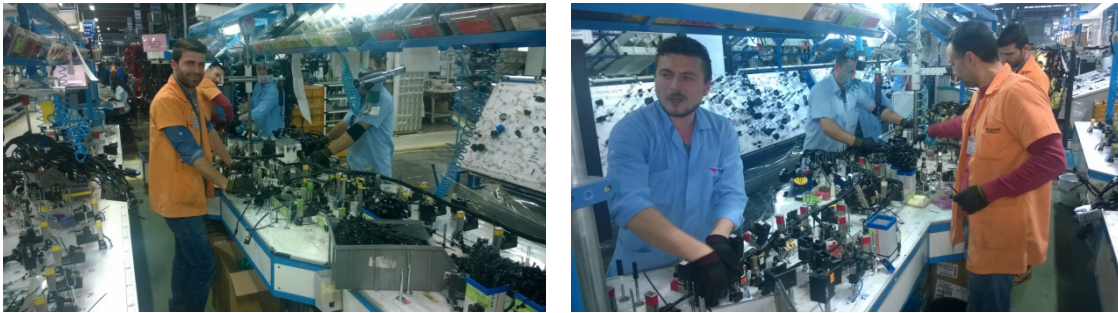
Şekil 4: Yeni Dizayn mandal masası operatör yerleşimleri
