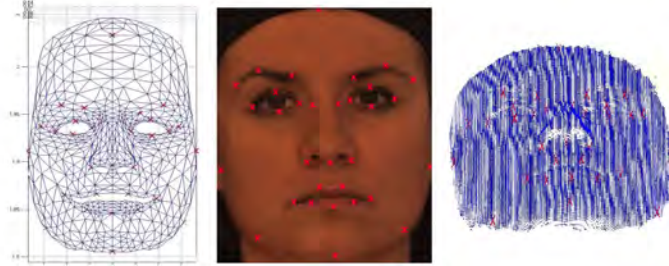
Şekil 4.2: Telkafes modeli üzerinde nirengi düğümleri, deneğe ait imge ve veri bulutu üzerinde nirengi noktaları.
