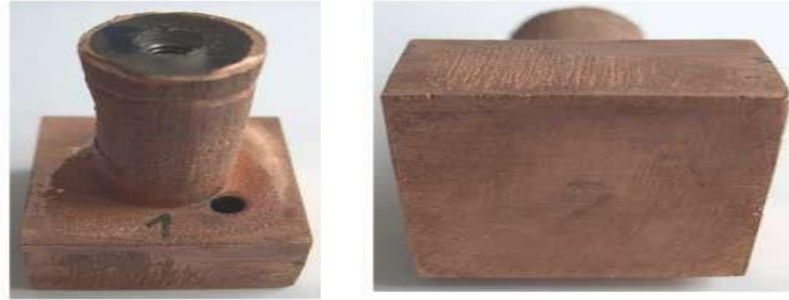
Resim 4.31: Testten önce bakır kaplı stereolitografik elektrot (Anıl ve diğerleri, 2006)
