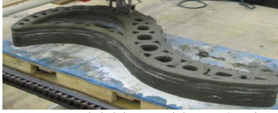
Resim 3.3: Somut bir nervürü tabakalı beton baskılı nesne (Austin ve diğerleri, 2012)
