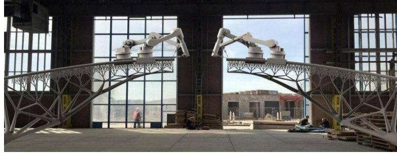
Resim 4.14: Hollanda'da MX3D ile devam eden üç boyutlu çelik baskılı köprüsü (URL70)
