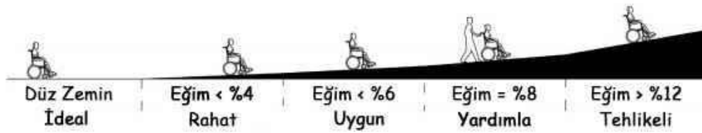
Şekil 29. Eğim = 100 x Aşılacak Yükseklik (m) / Yatay Uzaklık (m) = 100 x h/L
