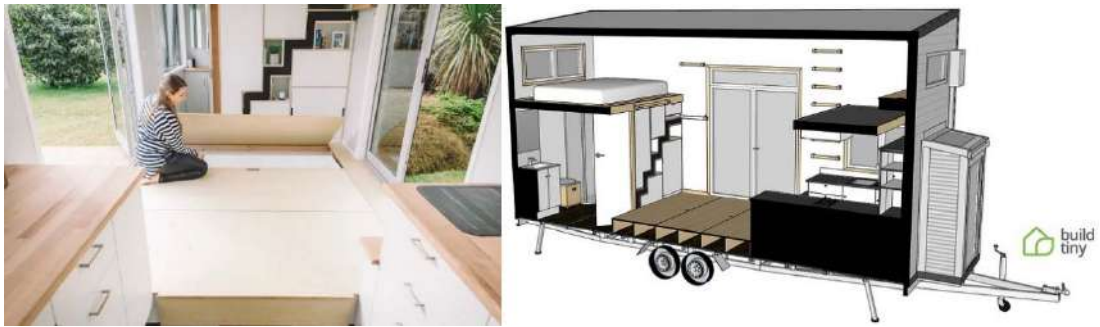
Şekil 5. 17. Millennial isimli taşınabilir mikro konutun depolama alanı, (www.buildtiny.co.nz, 2018).
