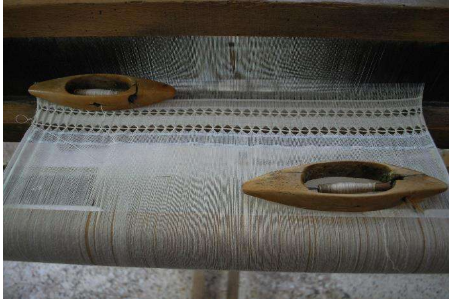
Şekil 3.25 Mekik (Ayşenur Kocakulak Arşivi, İbradı, 2022) Mekik, atkı ipliklerinin sarılı olduğu masırın yuvasıdır (Şekil 3.25).
