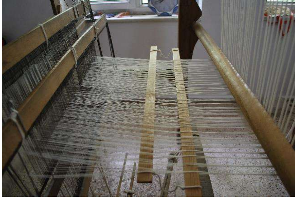
Şekil 3.22 Çubuk (Ayşenur Kocakulak Arşivi, İbradı, 2022) Çubuk, çözümlü ipliklerini sabitleyen çubuklardır (Şekil 3.22).
