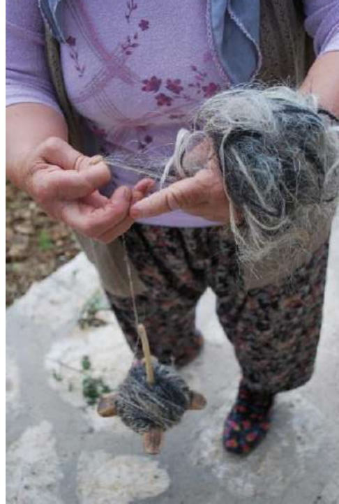
Şekil 2.12 İlengere İle Kıl İp Eğirme (Ayşenur Kocakulak Arşivi, İbradı, 2022) (Eğiren: Ayşe Tolon, kişisel görüşme, 17 Mayıs 2022)
