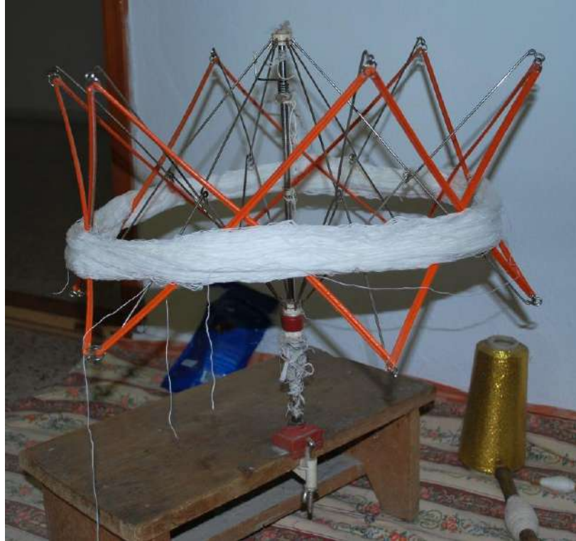
Şekil 3.31 Eski Düzende İplik Sarmak İçin Kullanılan Araç (Ayşenur Kocakulak Arşivi, İbradı, 2022)
