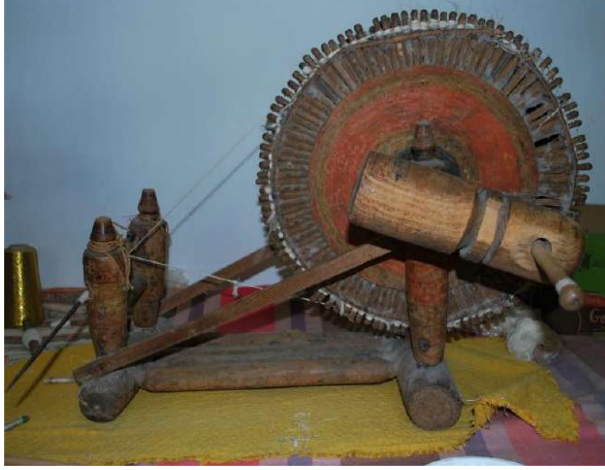
Şekil 3.30 Eski Düzende İplik Sarmak İçin Kullanılan Çark (Gülevcen) (Ayşenur Kocakulak Arşivi, İbradı, 2022)
