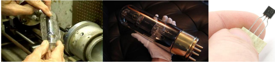
Resim 68 Sol baştan: Vakum tüp yapımı, büyük boy amplifikatörler için vakum tübü, transistör (Vakum tüpleri ve tranzistör görselleri, https://virtuabotix-virtuabotixllc.netdna-ssl.com/core/wp-content/uploads/2013/12/IMG_2990.jpg , http://cdn.head-fi.org/e/ef/500x1000px-LL-efcbfb78_KronzillaT-1610.jpeg , https://i.ytimg.com/vi/GAMRHcbE3g0/hqdefault.jpg . Erişim tarihi:02.12.2016, 13.41)
