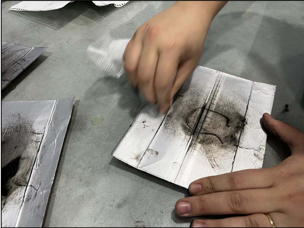
Şekil 4.11 Kalıptan Fazla Boyanın Temizlenme Aşaması
