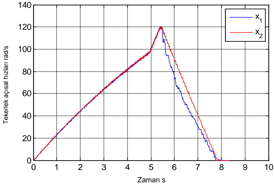
Şekil 23. ABS deney sisteminden ölçülen tekerlek hızları değerleri
