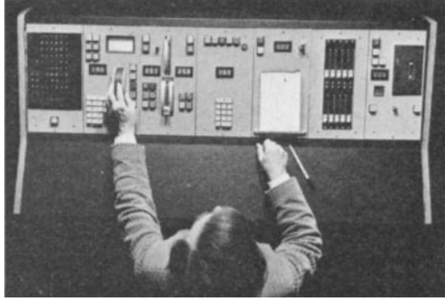
Resim 16 (Konsolun geliştirilmiş hali) control paneli, Royal Drury Lane, London, 1972 (Frederick Bentham, The Art of State Lighting , 1976, s.232)
